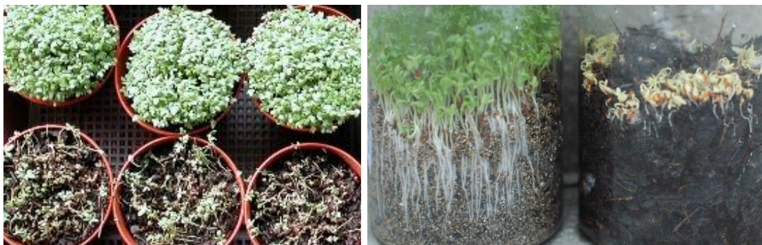
Links: Offener Kressetest. Die schlecht entwickelte Kresse in den Töpfen der unteren Reihe deutet auf einen Kompost mit phytotoxischer Wirkung hin. Rechts: Geschlossener Kressetest. Der Kompost im rechten Gefäss wirkt phytotoxisch.
