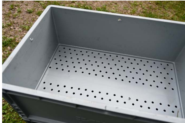
Abb. 2. Ansicht des Bodens der Behälter mit zahlreichen Löchern mit einem Durchmesser von 8,5 mm und der Lüftungslöcher oben an den Seiten der Behälter.
