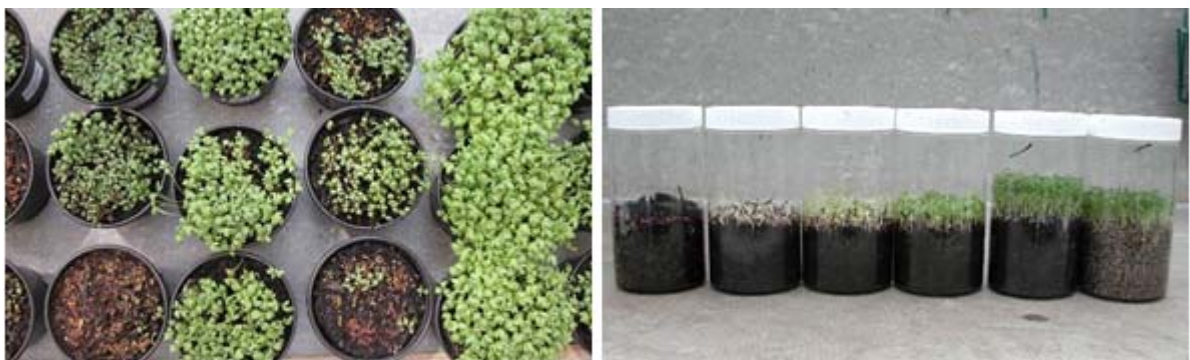
Phytotoxizitätstests, um die Verträglichkeit von Kompost mit Pflanzen zu beurteilen. Links: Offene Kresse. Rechts: Geschlossene Kresse.
